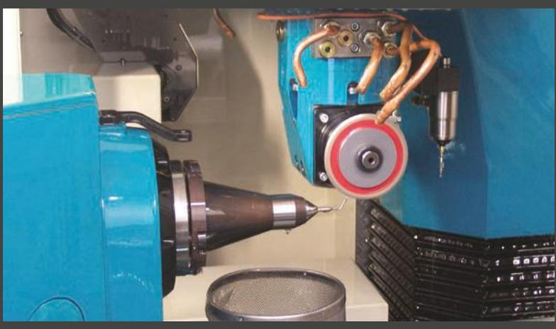
Durante cada procedimiento quirúrgico, un inserto ultrasónico oscila hasta 36.000 veces por segundo – una gran prueba de resistencia para el material. Esa es la razón por la que solo se utiliza acero inoxidable de calidad médica en la producción de los insertos Mectron. Y esa es también la razón por la que cada inserto ultrasónico tiene que pasar 12 fases de trabajo antes de que pueda llevar nuestro nombre.
