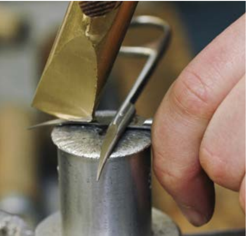
The process of “blades adjustment”, for reaching a perfect alignment, carried out by expert hands. Il processo di “regolazione” del taglio delle forbici eseguito abilmente da mani esperte.
