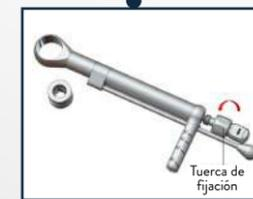
Retire el eje central del torquímetro.
